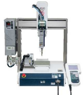
▲メタルスリーブ式 はんだ付けロボット J-CAT CMS
