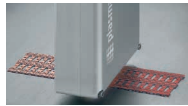
リードフレームへの酸化還元処理
